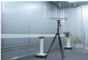
シールドルームは電磁波を遮断した部屋で、外部からの電磁波の侵入を防ぐとともに、内部からの漏洩を遮断できます。
