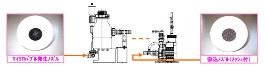
4. マイクロバブル発生ノズルは吸込ノズルに対して水平かそれ以上の高さに設置して下さい。
