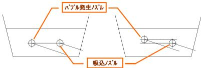
5. 浴槽水位が、マイクロバブルユニットより上方になるように設置して下さい。 また、吸込ノズル位置はポンプ部より上方に設置して下さい。
