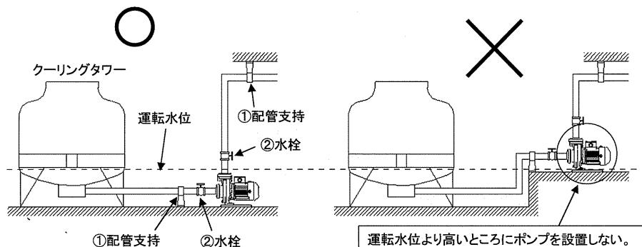
① ポンプに配管の重量がかかると、ポンプが故障する原因となりますので、十分な支持をしてください。
